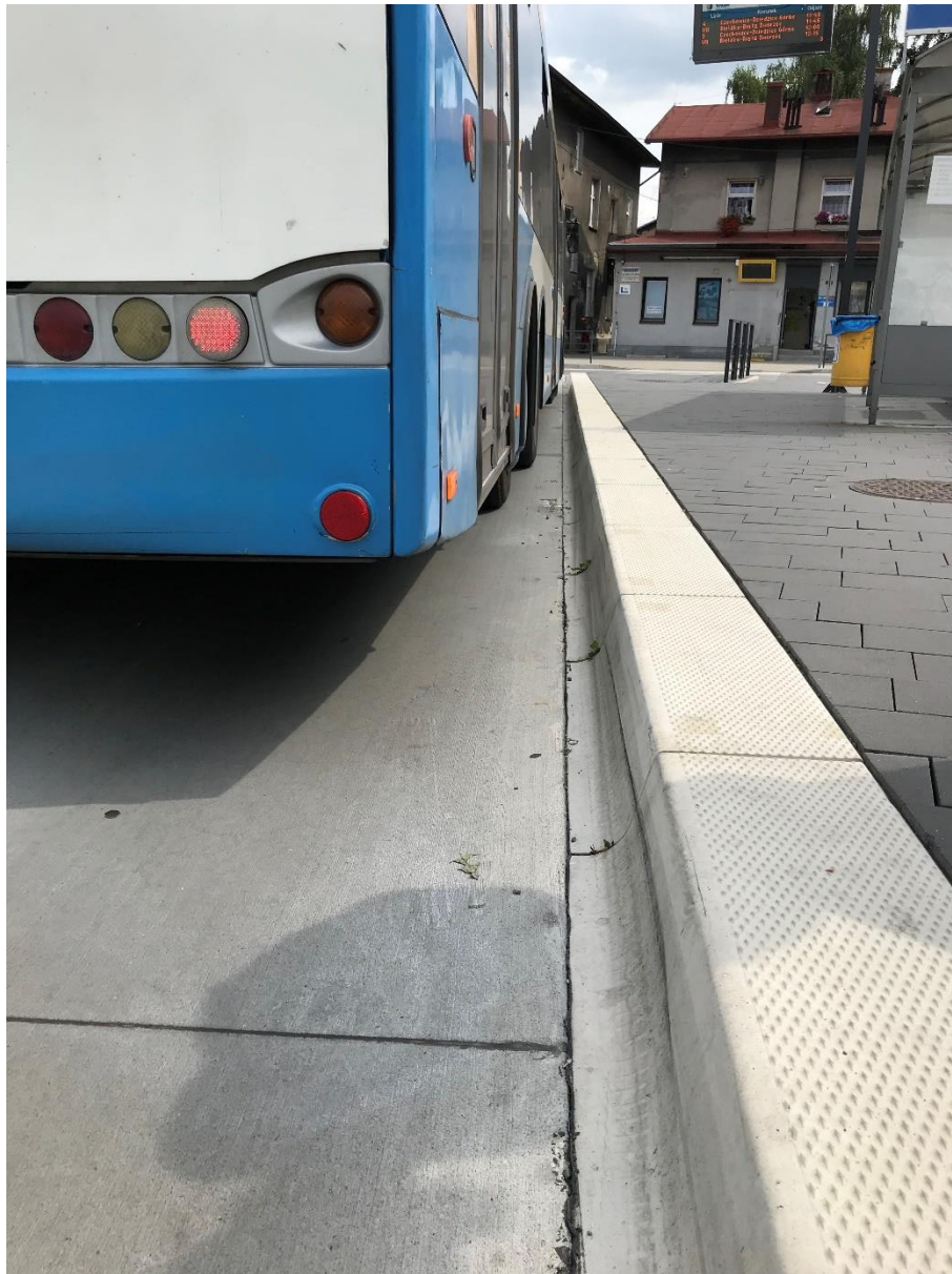
Rys. 9.10 Wyrównanie wysokości krawędzi peronowej z pierwszymi drzwiami autobusu
