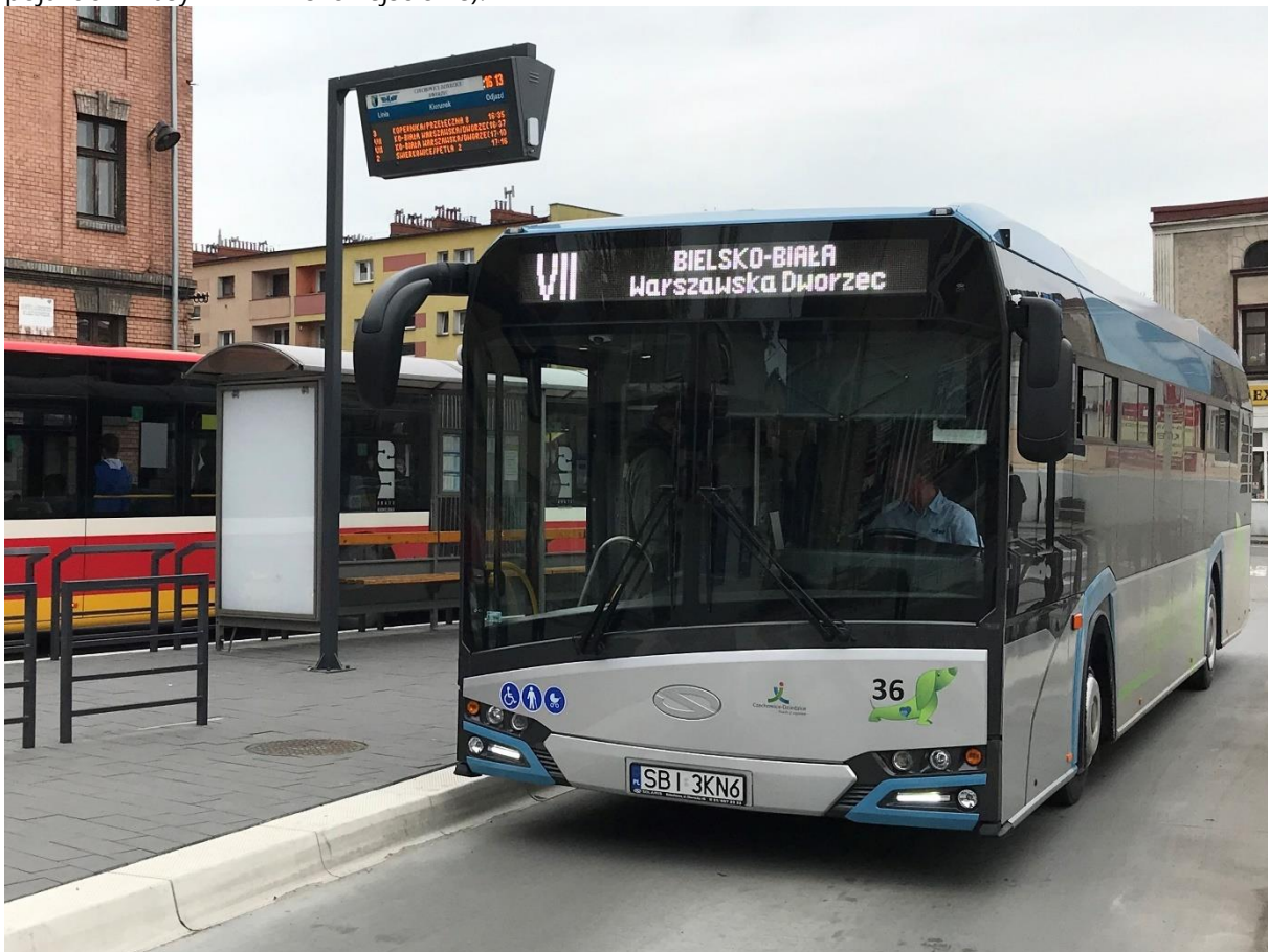
Rys. 9.9 W pełni niskopodłogowy hybrydowy autobus typu maxi wprowadzony do eksploatacji w 2018 r.
