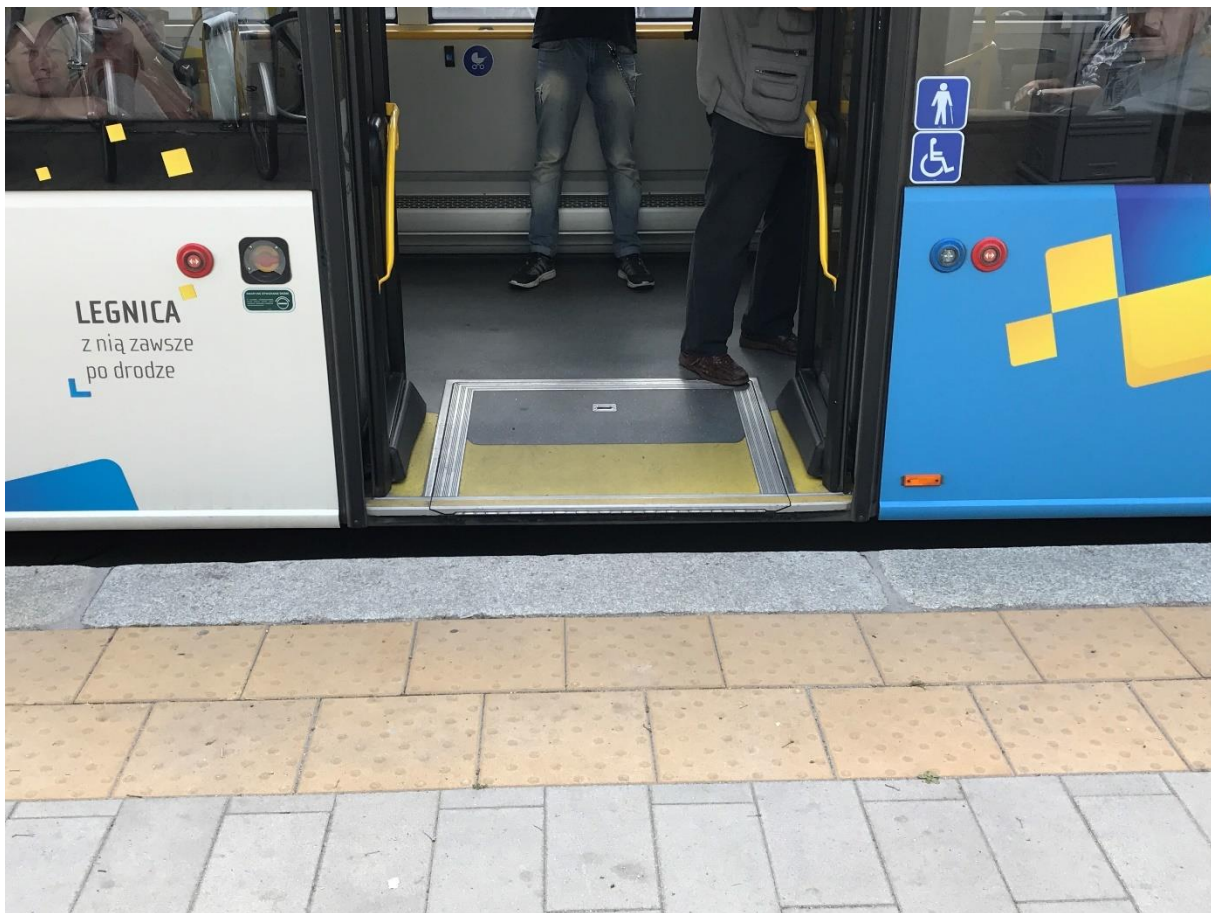
Rys. 9.12 Zminimalizowana przerwa między peronem przystankowym a autobusem
