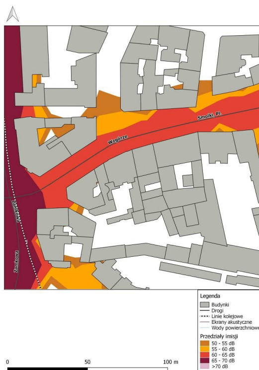
Rys. 10.20. Mapa Imisji L_N hałas drogowego dla ul. Wzgórze oraz Placu Franciszka Smolki na odcinku od ul. Zamkowej do ul. Stojałowskiego po zastosowaniu działań naprawczych
