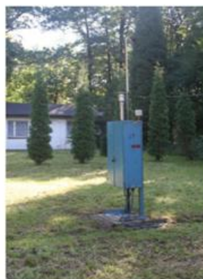
Rysunek 121. Aspirator pyłu PNS15 firmy Atmoservice zainstalowany na terenie uzdrowiska Goczałkowice-Zdrój (zdjęcie XXXX)
