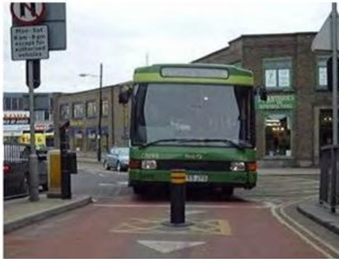
Rysunek 12-19 Automatyczny, „inteligentny” słupek przepuszczający tylko np. autobusy komunikacji miejskiej (źródło: materiały własne).
