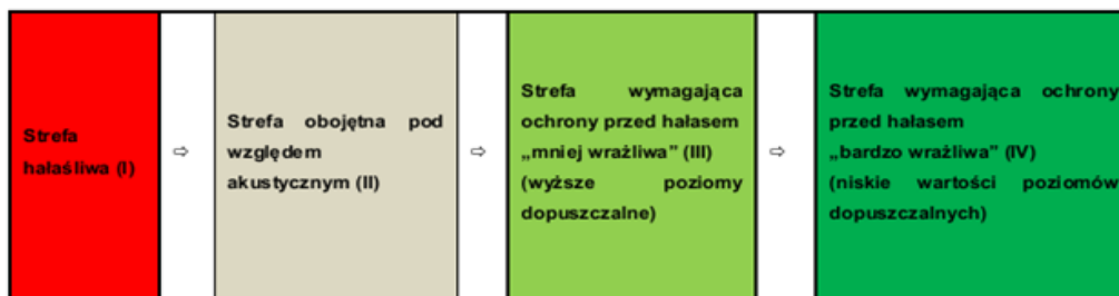
Rysunek 12-12 Przykład właściwego strefowania akustycznego
