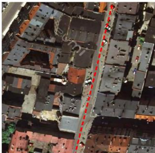
Rysunek 12-4 Wprowadzenie uspokojenia ruchu poprzez zmianę geometrii ulicy – pierwotny przebieg oznaczono kolorem czerwonym – Katowice ) źródło: materiały własne).
