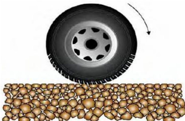
Rysunek 12-2 Asfalt porowaty o dużej zawartości próżni (źródło nynas.com)
