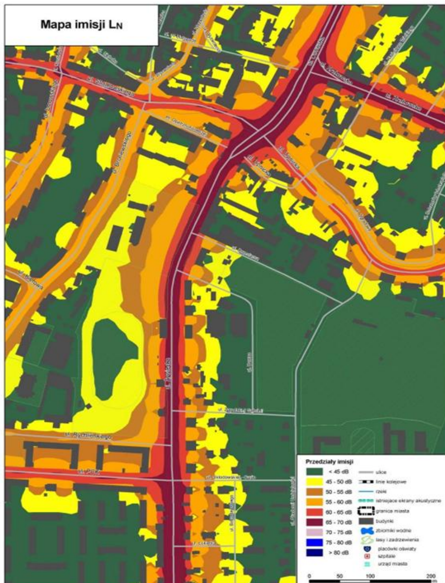
Rys. 9.22. Mapa Imisji L N hałasu drogowego dla ul. Żywieckiej – po zastosowaniu działań mających na celu poprawę stanu klimatu akustycznego
