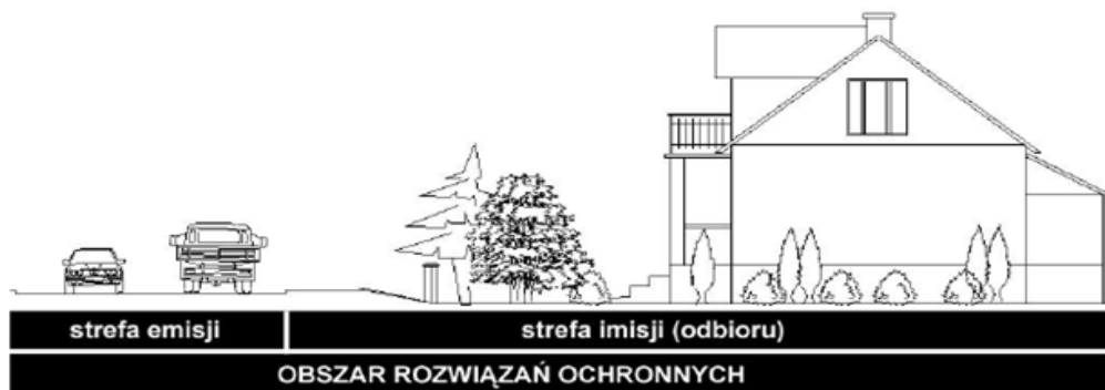
Rys. 6.4. Strefy emisji i imisji hałasu oraz obszar rozwiązań ochronnych w uniwersalnym podejściu do ochrony przed hałasem drogowym
