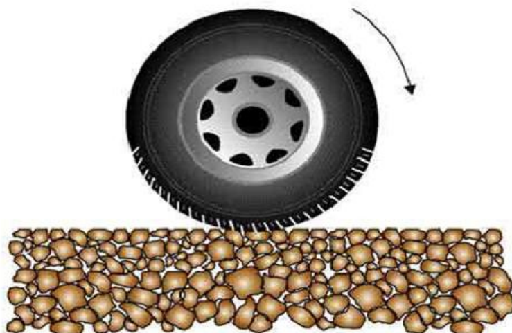
Rysunek 6-8 Asfalt porowaty o dużej zawartości próżni
