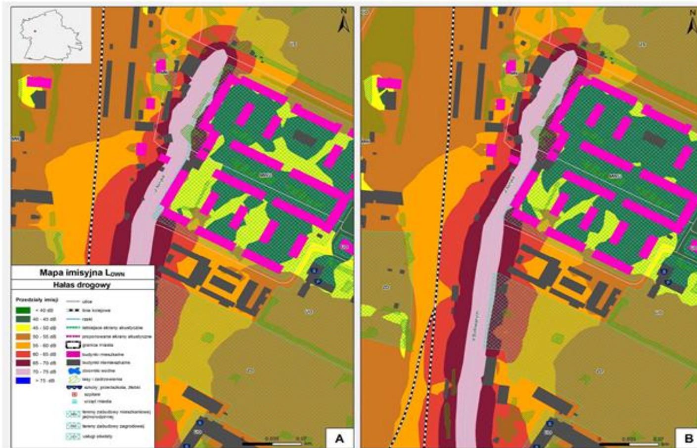
Rys. 5. Sytuacja przed (A) i po (B) zastosowaniu proponowanych działań ograniczających emisję hałasu do środowiska na ul. Asnyka.
