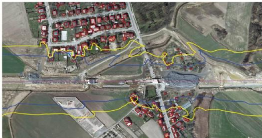
Rys. 3.1. Oddziaływanie akustyczne wybranego odcinka drogi przy zastosowaniu wskaźników L_{AeqD} i L_{AeqN}
