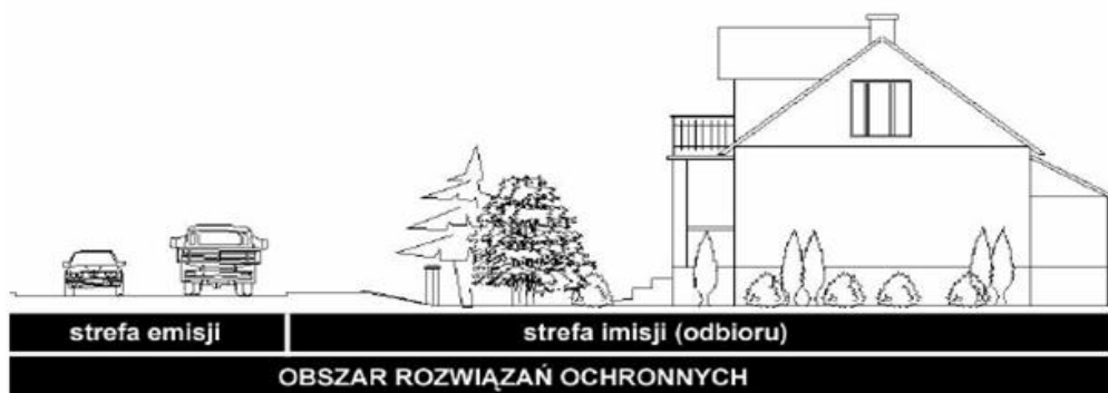
Rys. 6.5. Strefy emisji i imisji hałasu oraz obszar rozwiązań ochronnych w uniwersalnym podejściu do ochrony przed hałasem drogowym
