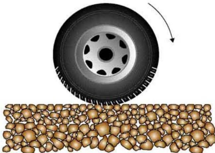
Rysunek 3-15. Asfalt porowaty o dużej zawartości próżni źródło: si.skom.waw.pl
