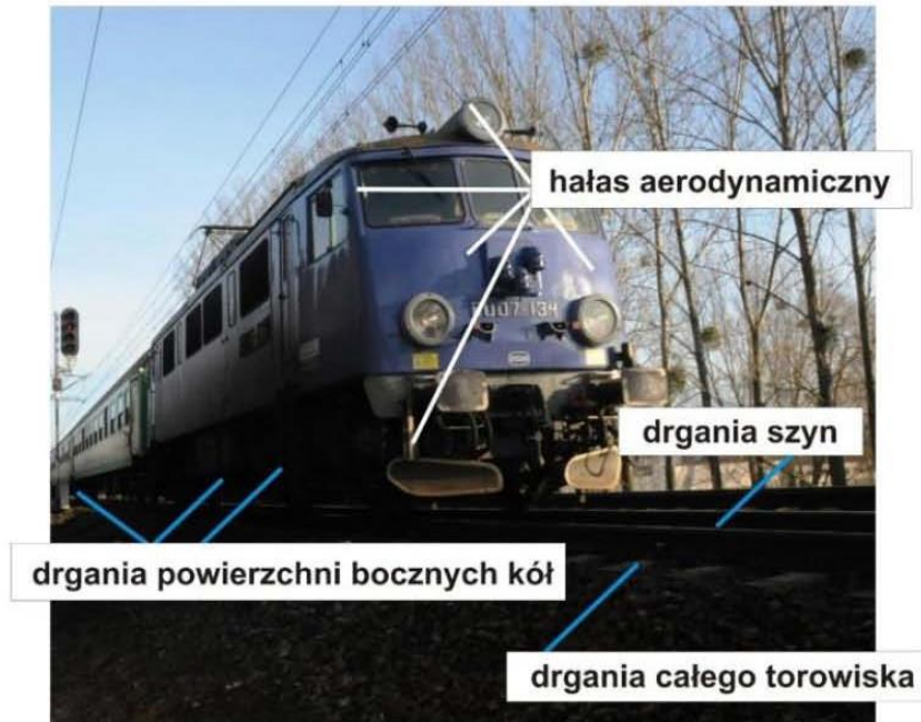
Rysunek 3-14. Wielkości wpływające na emisję i rozchodzenie się hałasu – hałas kolejowy źródło: techbud.com.pl
