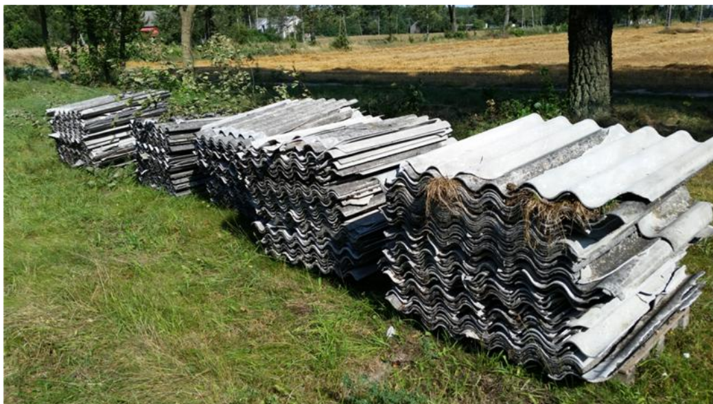
Rys. nr 2. Płyty azbestowe (faliste) złożone na paletach.
