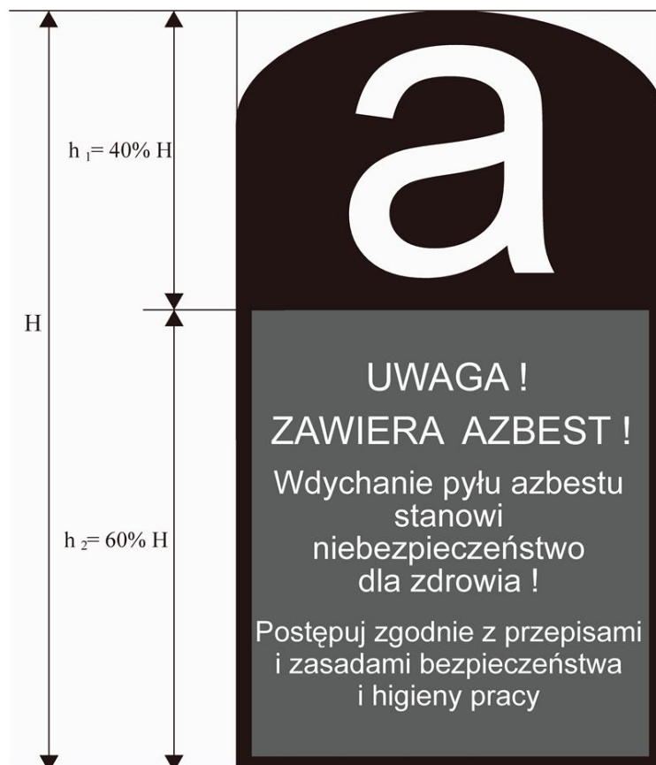
Rys. nr 3. Wzór oznakowania wyrobów, odpadów i opakowań zawierających azbest, a także miejsc ich występowania.
