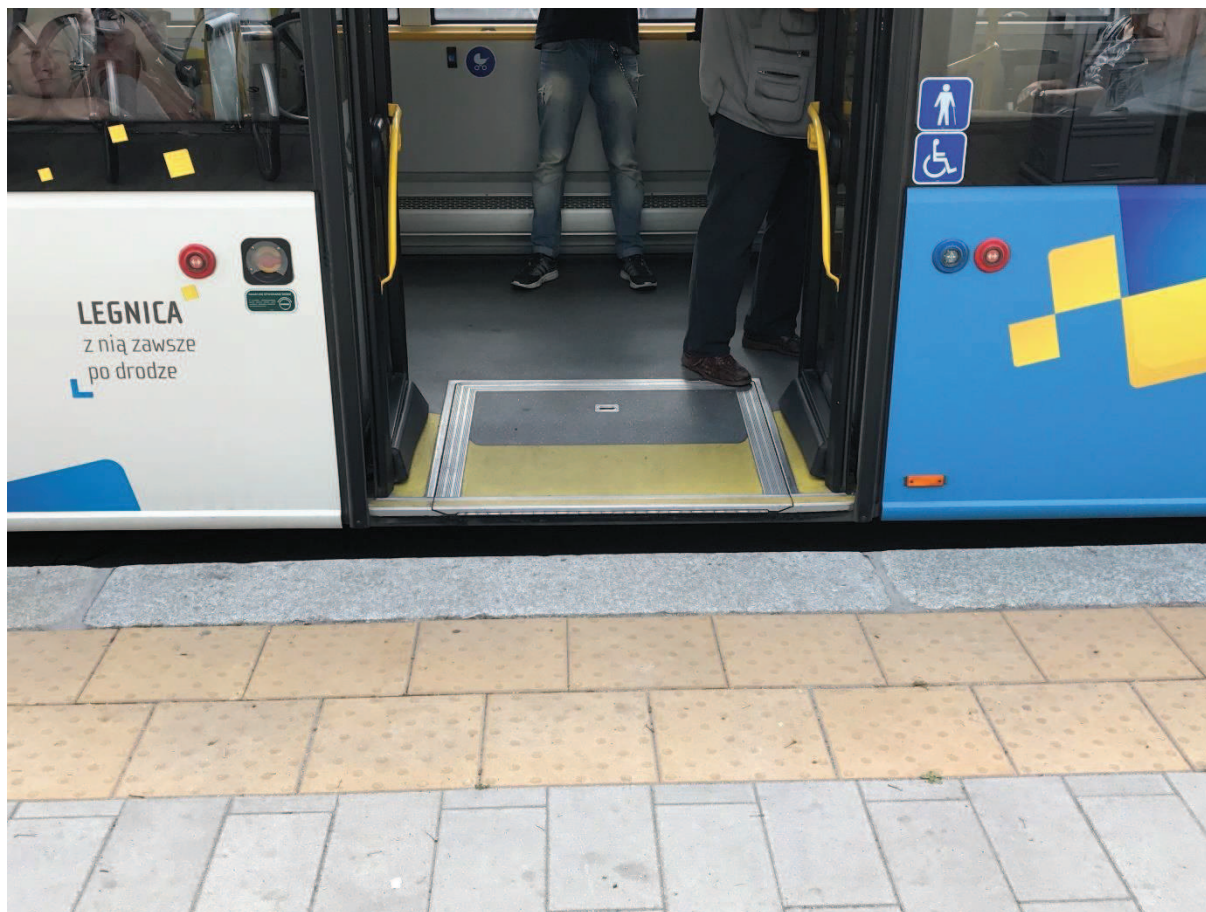
Rys. 9.10 Zminimalizowana przerwa między peronem przystankowym a autobusem
