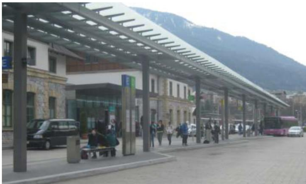
Rys. 12.3.2. Perony autobusowe przed dworcem kolejowym w miejscowości Landeck (Austria). Zaprojektowanie peronów w taki sposób ułatwia ich opuszczenie przez autobus.
