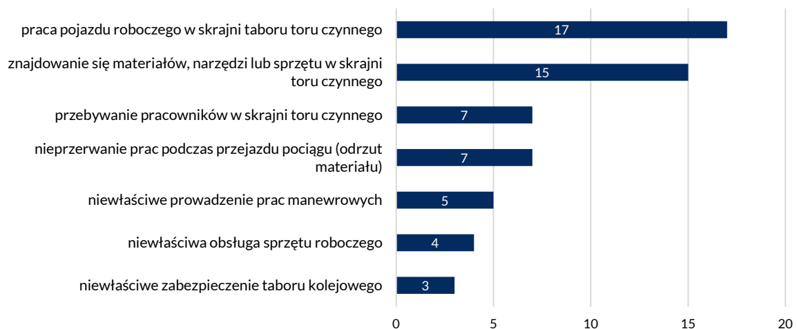
Rys. 20. Uszczegółowienie przyczyn zdarzeń zaistniałych w wyniku „wystąpienia nieprawidłowości w trakcie realizacji prac” na podstawie danych za lata 2019-2022
