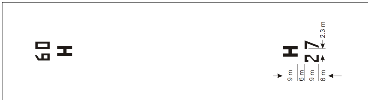
Rysunek 5-3. Oznakowanie identyfikacji strefy FATO oraz oznakowanie identyfikacji lotniska dla śmigłowców dla strefy FATO typu droga startowa
