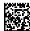
Rys. 4. Oznaczenie w symbolice GS1 DataMatrix z IZ 01, 21, 10 i 17 – tylko dla produktów leczniczych
