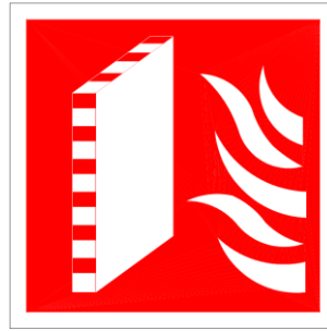
Rys. nr 1. Znak – „Ściana oddzielenia przeciwpożarowego”.
