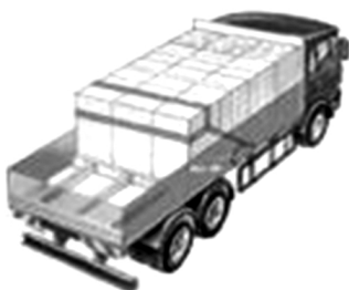
Rys. 5. Mocowanie przez nałożenie czołowe za pomocą zawiesia
