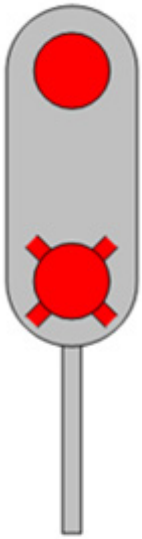
Rys. 205. Sygnał S 1a
