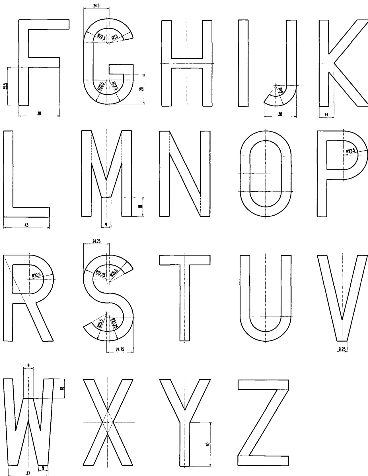
Rysunek 7. Wzory zwężonych liter do tablic samochodowych
